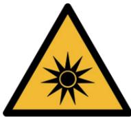
Questo simbolo indica la possibile presenza di radiazioni UV durante alcune fasi dell'operazione. La lampada allo xenon non deve essere rimossa dal suo alloggiamento quando lo strumento è in funzione.
