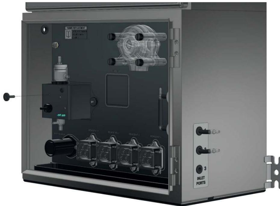
2. Ruotare la cella per allineare la fessura laterale al punto sul blocco cella, come mostrato.
