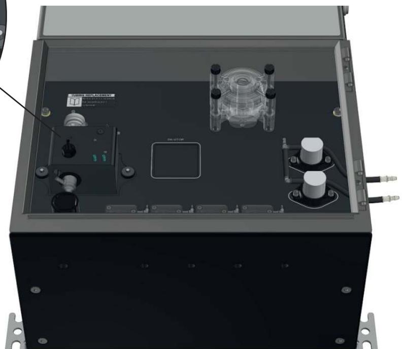
3. Rimuovere la cella alzandola. Se l'analizzatore è dotato di cella da 16 mm troverete un adattatore attorno ad essa, in quel caso aprire le due metà togliendo l'o-ring che le tiene insieme.
