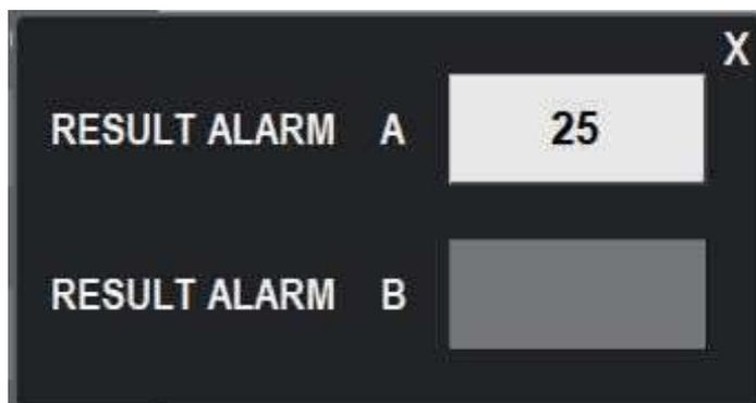
Cette fenêtre apparaît lorsque le bouton RESULT ALARM est sélectionné depuis la liste et permet à l'utilisateur de régler la valeur de seuil haut en valeur de COT. L'alarme B n'est disponible que lors de l'utilisation de l'option double voie d'échantillonnage.
