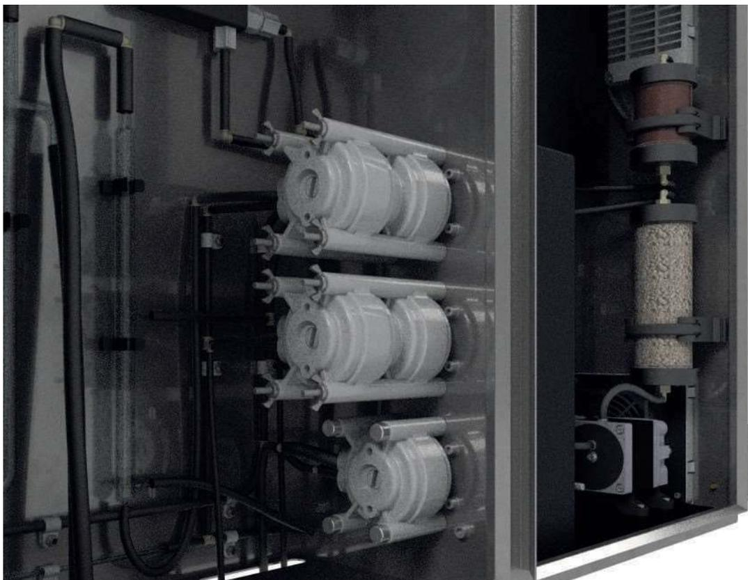
D - Déconnecter tous les tubes entrée/sortie de pompe de leurs raccords en prenant soin de repérer quel raccord sera nécessaire pour reconnecter chaque pompe.
