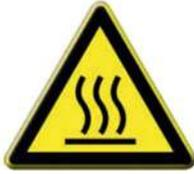
Ce symbole indique l'existence d'un danger de choc thermique en cas de contact avec les parties chaudes de la lampe UV, moteur de la pompe et compresseur. Avant de procéder à tout type d'activité de service sur l'analyseur, il convient de couper le courant.
