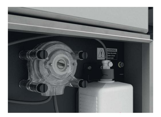
Il reagente è necessario per regolare il pH. A pH bassi lo ione idrogeno interferisce con l'elettrodo e dà false risposte.
